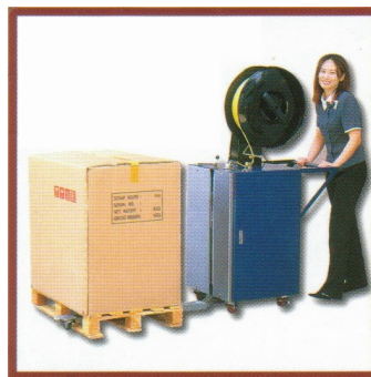
2: glijd het zwaard onder het pallet (juist ook tussen de laten door mogelijk)
