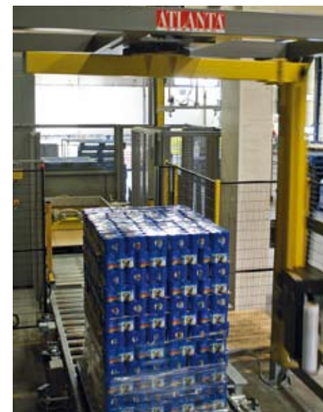
De finishing touch: de Atlanta foliewikkelaar, geleverd door Idépack, voorziet de pallets van een strak jasje
