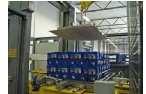
Het palletiseren van de klantorder, inclusief het plaatsen van tussenlegvellen, gebeurt volledig automatisch
