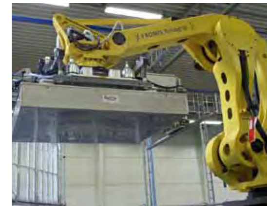
In één beweging neemt de robot met magneetkop een volle laag (216 blikken) af, om deze vervolgens op een van de vier afzettafels te plaatsen
