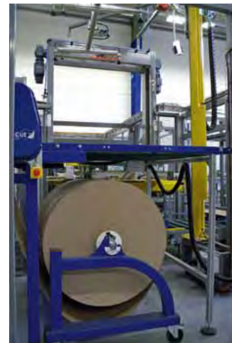
De tussenlegvellen worden ter plekke op maat gesneden
